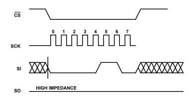
FIGURE 7. WRITE ENABLE LATCH SEQUENCE
