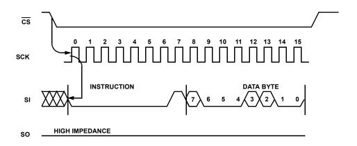
FIGURE 9. STATUS REGISTER WRITE SEQUENCE
