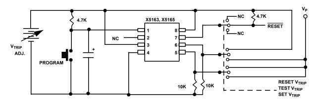
FIGURE 4. SAMPLE  $V_{\mathsf{TRIP}}$  RESET CIRCUIT
