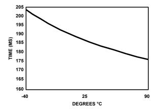
FIGURE 19.  $t_{\text{PURST}}$  VS. TEMPERATURE
