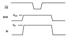
FIGURE 2. RESET  $V_{\mathsf{TRIP}}$  VOLTAGE
